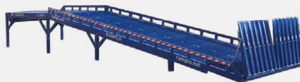
Queste rampe da piazzale sono dotate di una parte orizzontale lunga 2500 mm oltre a una sezione inclinata lunga da 8000 a 10000 mm. Questa particolarità della rampa da piazzale RL-FXH permette al conducente del carrello elevatore di allineare la sua posizione prima di entrare/uscire dal magazzino, dal carro o dal furgone, in modo che le forche del carrello elevatore siano parallele al piano orizzontale, che aiuta a prevenire i danni alla merce e all'attrezzatura.
